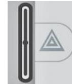
Abbildung 36. Warnblinktaste und Bildschirmsymbol.
