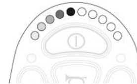
Abbildung 161. LEDs an der Batteriespannungsanzeige.
