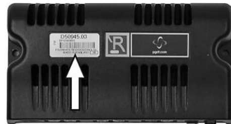
Abbildung 218. Kennnummer des Leistungsmoduls.
