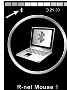
Abbildung 57. Der Pfeil zeigt auf das blinkende Bluetooth®-Symbol.
