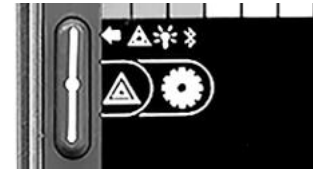
Abbildung 62. Taste zum Aufrufen der Einstellungen im Bluetooth®-Modus.
