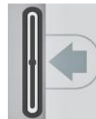
Abbildung 38. Blinkertaste links und Bildschirmsymbol.
