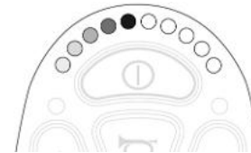
Abbildung 160. LEDs an der Batteriespannungsanzeige.
