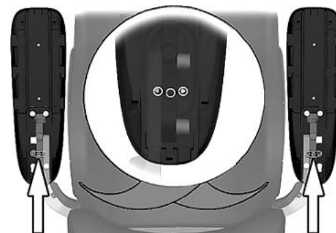
Abbildung 126. Endposition der Armlehenschwenkvorrichtung einstellen.
