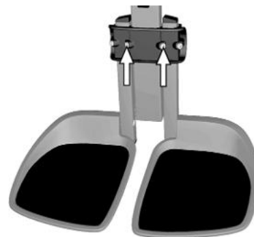
Abbildung 1.33. Einstellungsschrauben für die Beinstützenlänge.
