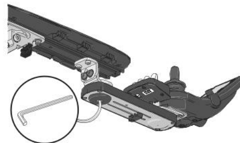
Abbildung 145. Die Position der Schraube auf des Parallelpulthalters.
