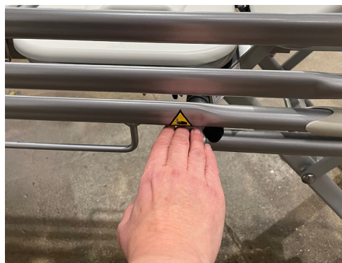
Der Abstand zwischen dem Drehgelenk und der unteren Querstrebe eines durchgehenden Seitengitters beträgt weniger als 25 mm.
