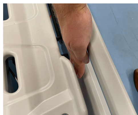
Der Abstand zwischen der Matratzenhalterung und dem Seitengitter beträgt weniger als 25 mm.
