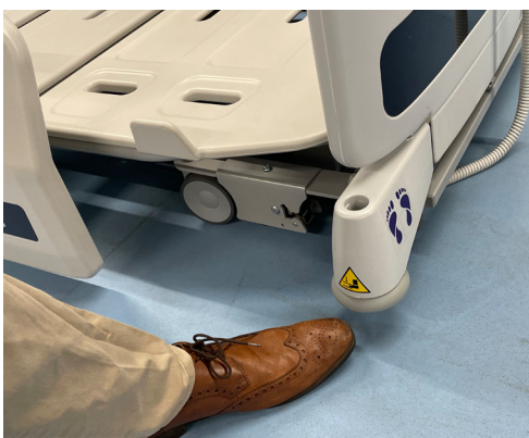
Der Mindestabstand zwischen der Unterseite eines Bettkantenschutzes und dem Boden beträgt 120 mm.
