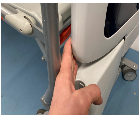
Der Abstand zwischen Kopfteil und Seitengitter beträgt etwa 25 mm.
