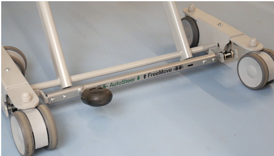
Lenksperre aktiviert – AutoSteer™-Pedal heruntergedrückt
