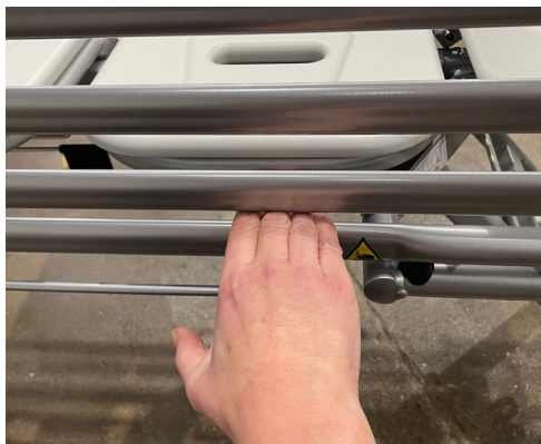
Der Abstand zwischen dem Bettgestell und der Querstrebe eines durchgehenden Seitengitters beträgt weniger als 25 mm.
