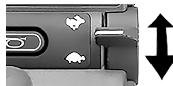
Abbildung 66. Im Bluetooth®-Modus wird der rechte Hebelschalter verwendet, um nach oben oder unten zu scrollen.
