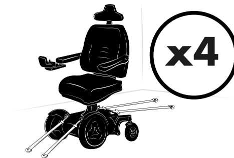
Abbildung 164. Am Rollstuhl befinden sich vier Zurrpunkte. Das Bild zeigt einen unspezifischen Rollstuhl mit Zurrpunkten.
