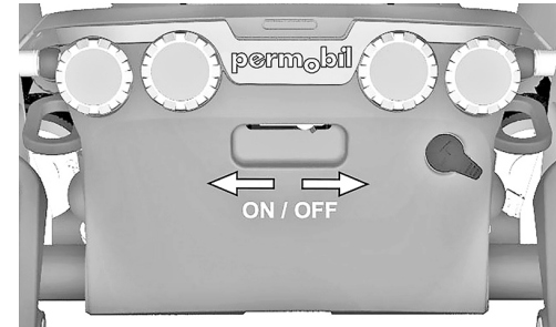
Abbildung 191. Hauptschalter unter dem Permobil-Logo auf der hinteren Abdeckung.
