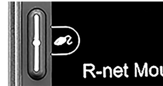
Abbildung 63. Linke Taste für linke Mausklicks.
