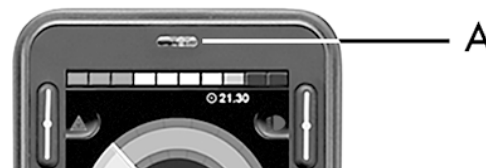
Abbildung 69. Position des IR-Empfängers.
