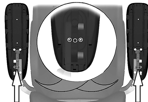
Abbildung 126. Endposition der Armlehenschwenkvorrichtung einstellen.
