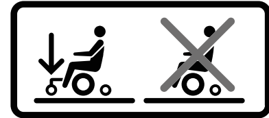
Abbildung 6. Die Stützräder müssen während der Fahrt stets angebracht sein.
