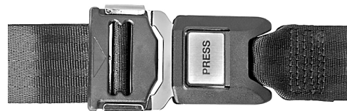
Abbildung 148. Gurtschnalle richtig in Schnellverriegelung verriegelt.
