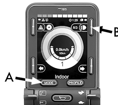
Abbildung 57. Es gibt zwei Möglichkeiten für den Zugriff auf ein Bluetooth®-Gerät.
