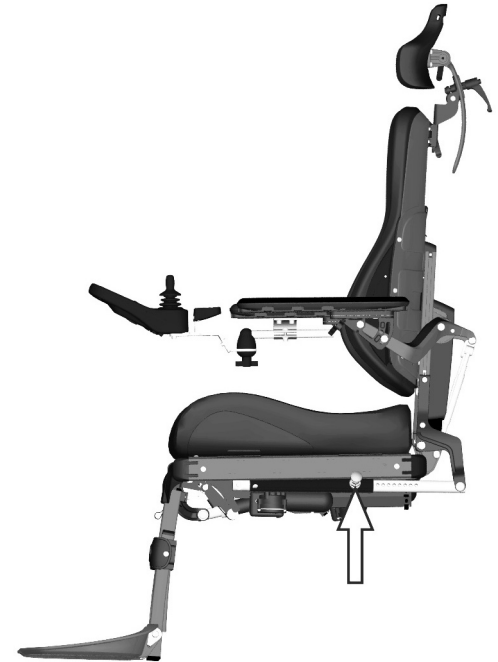
Abbildung 17. Manuelles Klemmrohr für die Rückenlehnenneigung.
