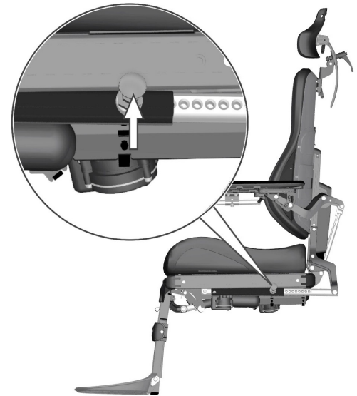
Abbildung 18. Manuelle Einstellung des Rückenlehnenwinkels.
