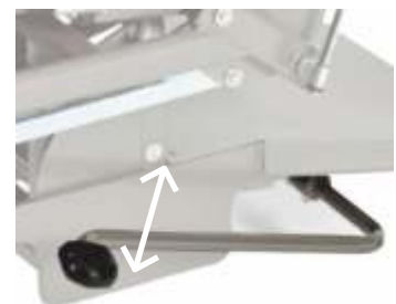
Abb. 3: Betätigung des Fußhebels zur Höhenverstellung
